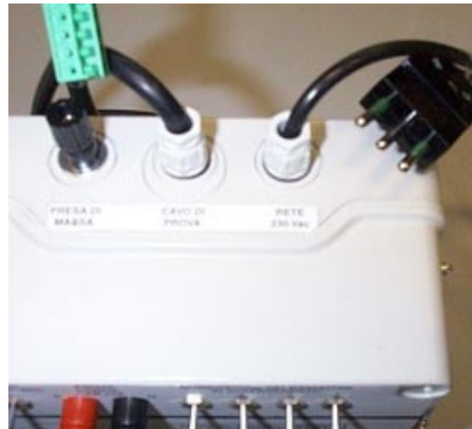
2. Particolare del TTA 628 con il cavo di alimentazione e quello di prova. Sulla sinistra c'è l'attacco per la presa di massa.
