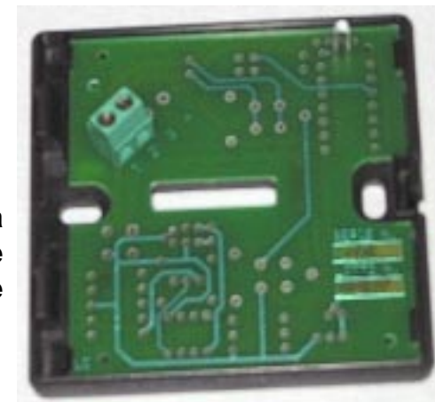
Sonda di minima SAB010. Particolare del morsetto per i due fili di collegamento.
