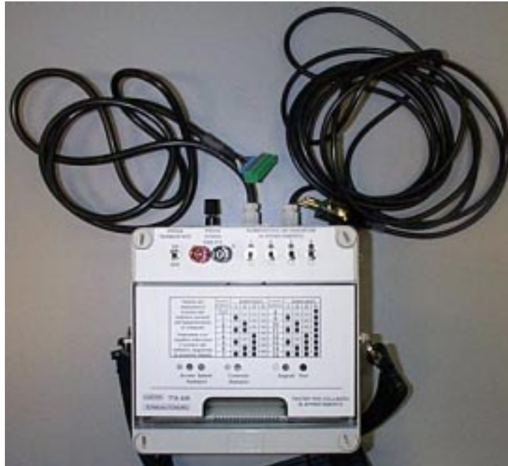
1. Tester per collaudo del Termoautonomo in appartamento. Visione d'insieme con cavi.
